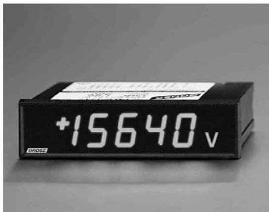
Цифровой панельный индикатор PM 821 представляет собой 4 1/2-разрядный измерительный прибор в половинном форм-факторе DIN с фронтальными размерами 96x24 мм. Такие характеристики, как увеличение долгосрочной стабильности, точности и очень высокой надежностью были достигнуты благодаря использованию высококачественных компонентов. Каждый прибор поставляется с предварительными испытаниями в течение более 100 часов.
